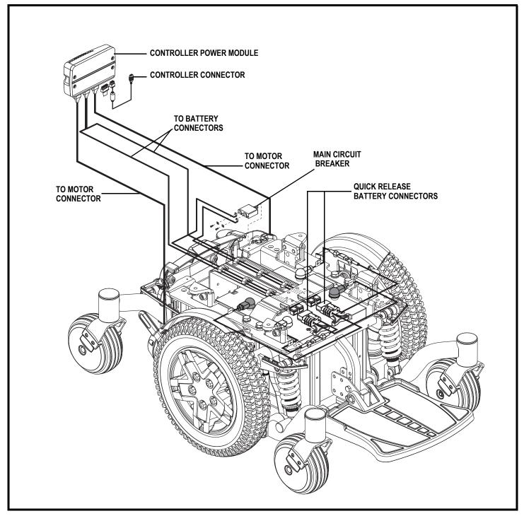
Figure 7. Q6 Edge Electrical Components
