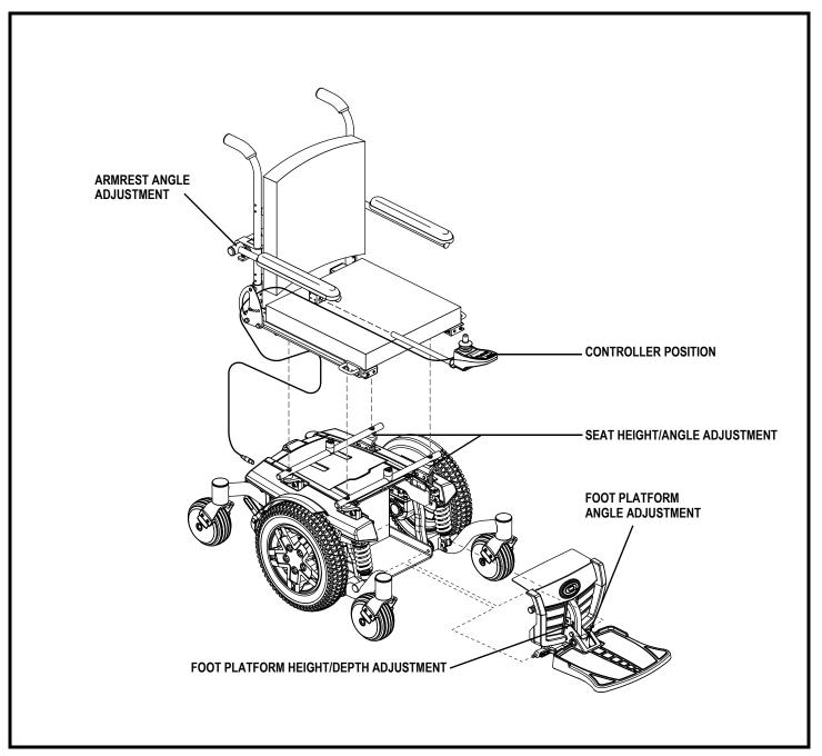
Figure 10. Q6 Edge Assembly View
